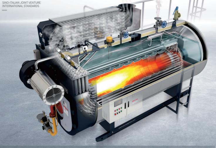
科诺超低氮冷凝蒸汽锅炉,采用高效率低应力卧式湿背内燃烟气二回 程结构,将大量低温受热面布置在本体受压区外,加大蒸汽空间提高蒸 汽干燥度,降低锅炉热应力,避免锅炉本体内冷凝腐蚀,从而提高本体 热效率。且注重顶层设计,将锅炉本体、空气预热器、节能冷凝一体机、 Cavallo卡瓦诺变频分体式超低氮燃烧器、智能控制系统进行完美集
