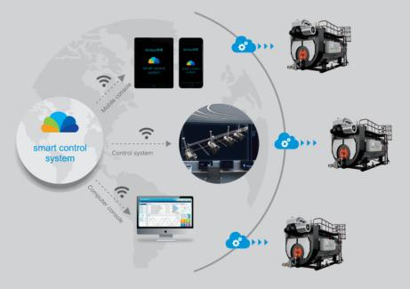
科诺锅炉物联网技术, 搭载科诺云平台, 涵盖锅炉运行现状、锅炉节能 减排数据库等锅炉信息(报告)采集、传输、分析与通讯功能,内置智能网 关,直接接入锅炉物联网系统,可同时应用于移动端和PC端,实现锅炉 系统的远程多点实时连接。
